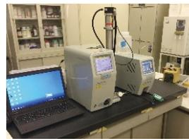
走査型粒子測定装置に粒径分布の測定
